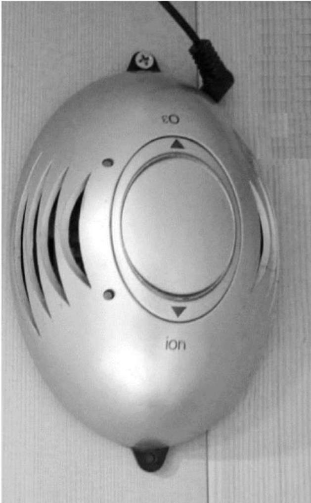
**Il pulsante ION** serve per accendere il ionizzatore. Dopo aver premuto, il diodo di controllo si illumina - verde.
