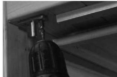
Inserire la parte principale nella base delle cerniere e rimuovere la vite esagonale dalla parte principale, installare la porta sulle cerniere, assicurarsi che i fori della porta siano allineati con le cerniere, quindi avvitare le viti esagonali per fissare il vetro, assicurarsi che le viti esagonali siano rivolte verso l'interno.
