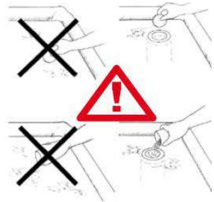
Il contatto del materiale delle piscine con prodotti cloranti concentrati provoca lo sbiancamento del materiale stesso, senza però indebolire la struttura.
