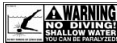
CARTELLO SEGNALETICO DA POSIZIONARE SUL RIVESTIMENTO INTERNO SOPRA LA LINEA DELL'ACQUA NEL LATO OPPOSTO ALL'INGRESSO DELLA PISCINA.
