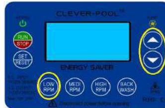
Premere il pulsante RUN/STOP per passare alla modalità di funzionamento, in modo da avviare la pompa. Quando il timer del clorinatorio si spegne, il S4S memorizza la velocità e la riprende alla riaccensione.
