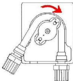
**FR** Enlever le vieux tube en débloquent d'abord le raccord de gauche. Faire tourner le porte-galet dans le sens de la flèche jusqu'au raccord de droite afin de libérer le tube péristaltique.
