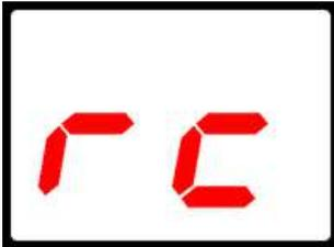
**FR** Si à la fin du calibrage le display montrera écrite "rc", pousser le bouton Cal pour sortie et retour à la lecture. Répéter la procédure, si après le seconde tentative paraîtra encore écrite "rc", cela veut dire que l'électrode n'est pas en bon état et qu'il doit être changé.
