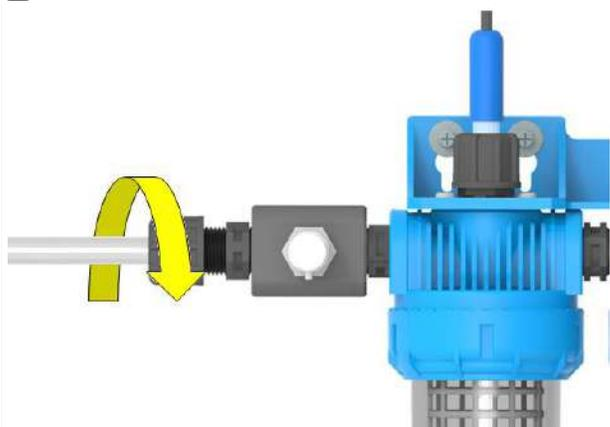
**IT** La connessione del tubo in PE 4x6 al raccordo **a** e del tubo 4x6 in PE al raccordo **m** della figura 1 è molto semplice. Far passare il tubo attraverso la ghiera, quindi il ferma tubo ed infine infilare il tubo nel raccordo **p** ed avvitare la ghiera **g** come in figura 3
