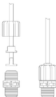
**FR** Lier l'autre extrémité du tuyau en PE 4x6 à le raccordement 1/2" et l'autre extrémité du tuyau en PE 4x6 à l'autre raccordement 1/2" de la manière suivante . Dévisser l'embout bleue du raccordement et faire passer le tuyau à travers l'embout, donc l'adaptateur et finalement insérer avec une action contemporaine de pression et rotation au bout le tuyau fin sur l'attaque conique du raccord( porte gomme); bloquer le tout en serrant au fond l'embout bleue.
