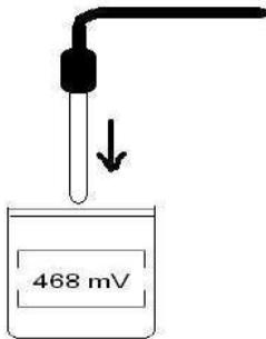
**FR** Insérer la sonde de Rx dans la solution tampon au 468mV. Attendez quelques secondes pour la stabilisation de la lecture.
