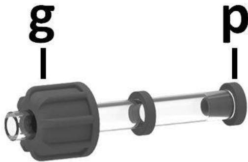
**FR** Le raccordement de le tuyau en PE 4x6 a le attaque **a** et de le tuyau en PE 4x6 a le attaque **m** est très simple. Il suffit faire passer le tuyau à travers l'embout **g**, donc l'adaptateur et finalement insérer avec une action contemporaine de pression et rotation au bout le tuyau fin sur l'attaque conique de la connexion ( porte gomme) **p** et serrer le écrou **g** comme dans la figure 3.
