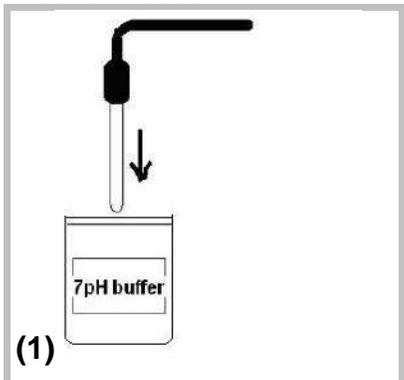
**FR** Insérer la sonde de pH dans la solution tampon au pH 7. Attendez quelques secondes pour la stabilisation de la lecture.
