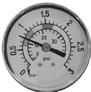
0,8 kg/cm 2 - 11,4 PSI: Pressione normale per il ciclo di filtrazione.
