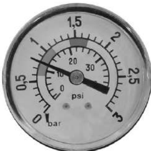
0,8 kg/cm 2 - 11,4 PSI: Normaldruck bei Beginn des Filtriervorganges.
