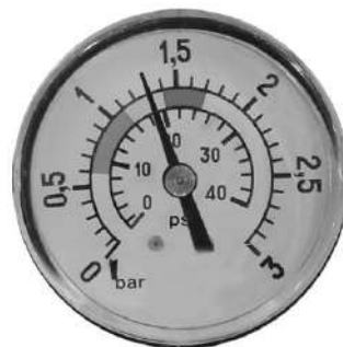
1,3 kg/cm 2 - 18,5 PSI: tlak ve filtru vyžadující provedení PROPLACHU
