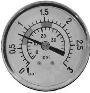
0,8 kg/cm 2 - 11,4 PSI: filitreleme sürecinin başındaki normal basınç
