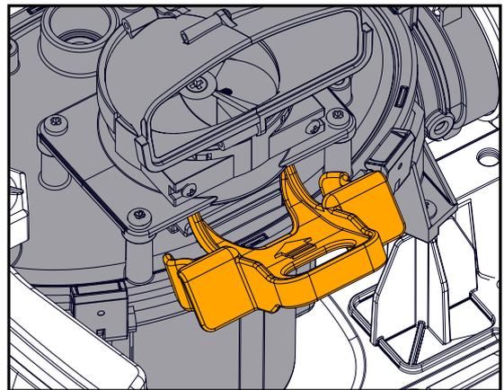
4. Inserire lo strumento di sicurezza della girante.
