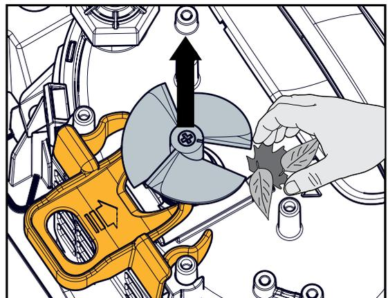
6. Se necessario, rimuovere la vite della girante e sollevare con attenzione ma con decisione la girante per pulire i detriti.
