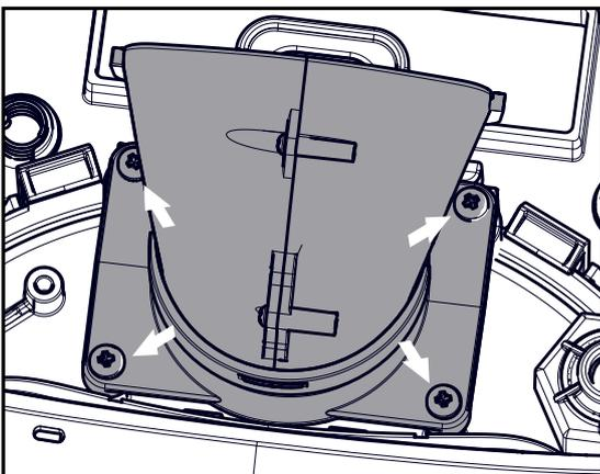
5. Rimuovere 4 viti e rimuovere il collettore di scarico
