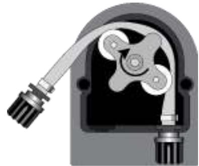
Den linken Anschluss vollständig freigeben und dabei leicht nach außen ziehen und den Läufer in Richtung des kreisförmigen Pfeils drehen, so dass der Schlauch am rechten Anschluss freigegeben wird.
