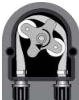
Posizionare il rullo alle ore 7:05, ruotandolo nella direzione della freccia circolare.
