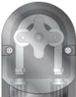
Ouvrir le couvercle de la pompe et libérer le tuyau en tirant sur le connecteur gauche vers le haut.
