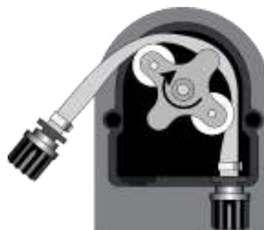
Rilasciare completamente il connettore di sinistra, tenendolo teso verso l'esterno, e ruotare il rullo nella direzione della freccia circolare in modo da liberare il tubo verso il connettore di destra.
