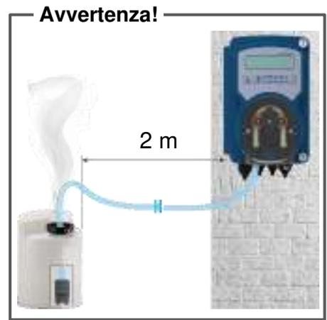
Verificare che la pressione di iniezione sia inferiore a 1,5 bar
