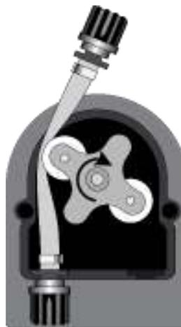
Den linken Anschluss in sein Gehäuse schieben und den Schlauch unter der Läuferführung durchschieben. Den Läufer in Richtung des kreisförmigen Pfeils drehen und dabei gleichzeitig den Schlauch in den Pumpenkopf einführen, bis der rechte Anschluss erreicht wird.
