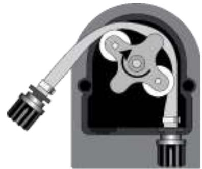
Suelte por completo el conector izquierdo, manteniéndola tensa hacia fuera, y gire el rolo en la dirección de la flecha circular para que la manguera quede liberada hasta el conector derecho.
