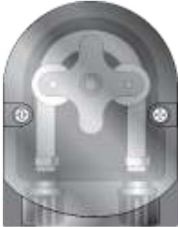
Den Pumpendeckel öffnen und den Schlauch durch Hochziehen des linken Anschlusses freigeben.
