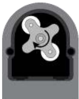
Placer le rouleau à 7h05, en le tournant dans le sens de la flèche circulaire.
