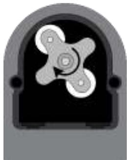
Den Läufer auf 7:05 Uhr stellen, dazu in Richtung des kreisförmigen Pfeils drehen.
