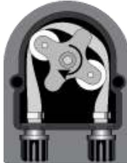
Den Rotor auf 7:05 Uhr stellen, dazu in Richtung des kreisförmigen Pfeils drehen.
