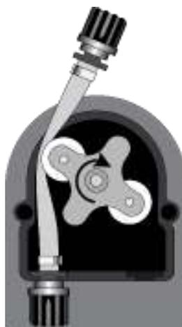
Inserire il connettore di sinistra nell'apposito alloggiamento e far passare il tubo sotto la guida del rullo. Ruotare il rullo nella direzione della freccia circolare, accompagnando contemporaneamente il tubo nella testata della pompa fino a raggiungere il connettore di destra.
