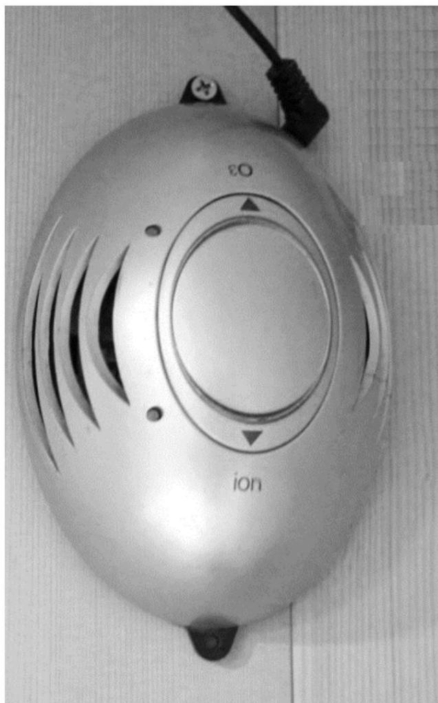
Il pulsante ION serve ad accendere lo ionizzatore. Dopo averlo premuto, il diodo di controllo si illumina di verde.
