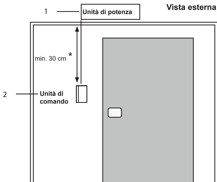
Fig.4 Posizione dell'unità di comando
