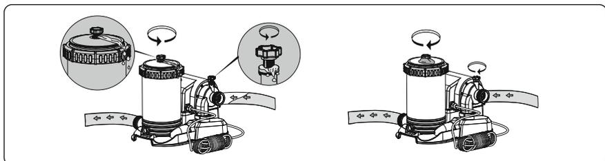
**IMPORTANTE: NON UTILIZZARE LA POMPA A FILTRO SENZ'ACQUA** – Assicurarsi che le valvole di entrata e uscita della piscina siano completamente coperte dall'acqua prima di azionare la pompa a filtro.
