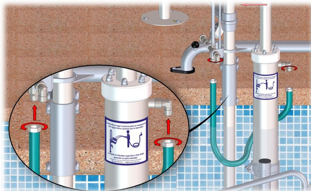
**Passo 12.** Spurgare la presa d'acqua prima di effettuare il collegamento idraulico.
